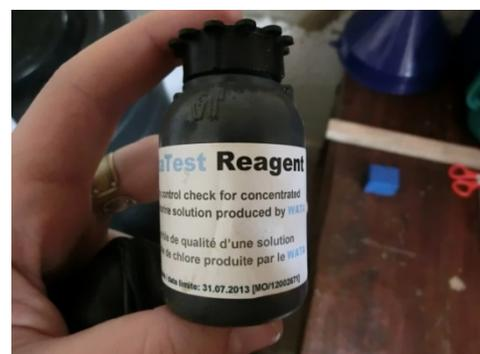
Réactif Wata Test, permettant le contrôle final de la concentration en chlore actif
